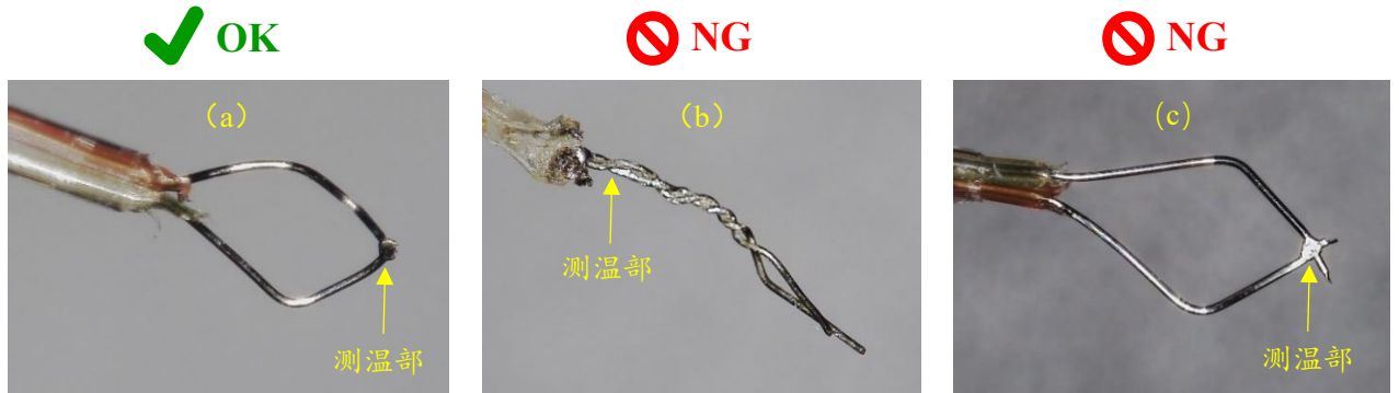
图 3 热电偶的测温位置
